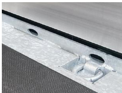
System wielopunktowego mocowania ładunku Safety Lock Lashing Rings
